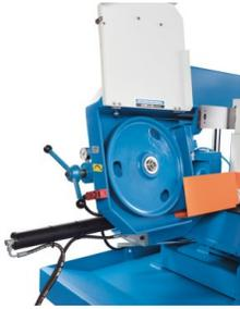
*Ein Manometer garantiert die richtige Sägeblattspannung*
