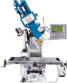
*Schwenkbarer Fräskopf mit verfahrbarer Pinole*
