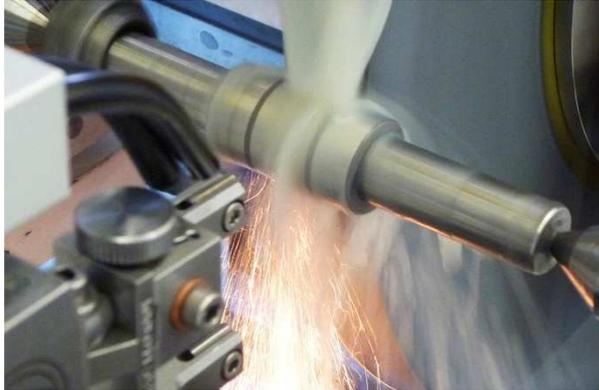
**Rundsleifen** Ø 0,5 – 100,0 mm, Länge 420,0 mm,
