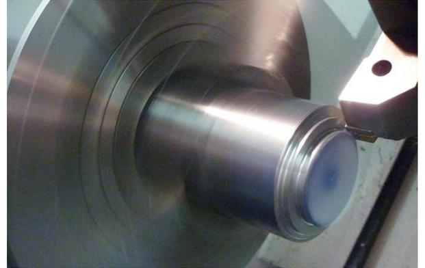
**Kurzdrehen** Bis  $\varnothing$  65,0 mm ab Stange, CNC-Maschinen mit angetriebenen Werkzeugen.
