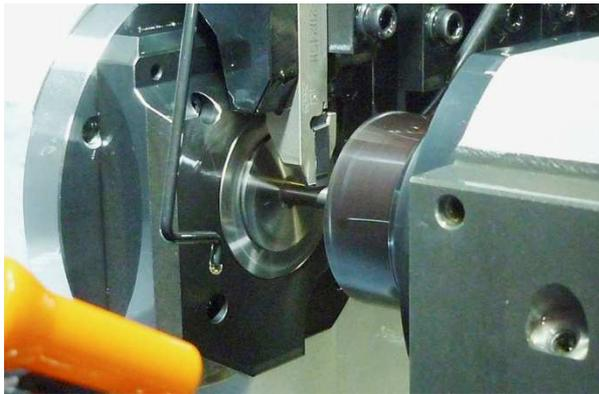
**Langdrehen**  $\varnothing$  1,0 – 32,0 mm ab Stange, Anzahl Achsen: 7, CNC-Maschinen mit angetriebenen Werkzeugen und Tieflochbohren ab 0,2 mm.
