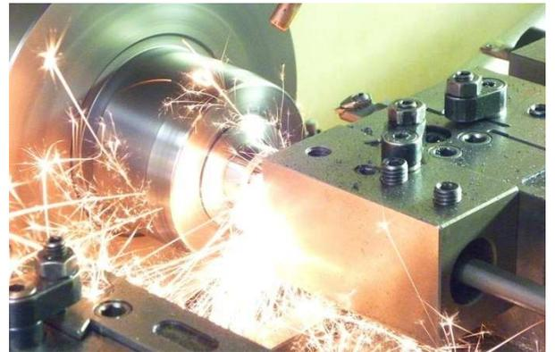
**Hartdrehen** Auf CNC Maschinen, bis 65 HRC.
