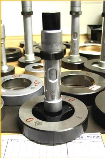
Alle Messinstrumente und Lehren, die von uns geliefert werden, sind eindeutig durch eine einzigartige Gerätenummer identifizierbar und werden, falls gewünscht, gegen eine geringe Gebühr überprüft, neu kalibriert und zertifiziert.
