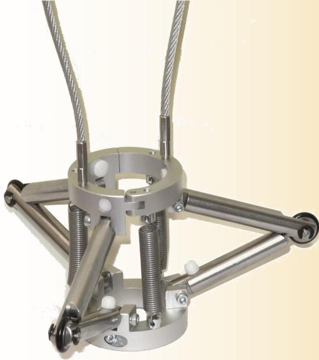
Der MICROTEST<sup>®</sup> -Tripod unterstützt den Innen-Micrometer mit Verlängerung, um eine optimale Vorzentrierung in der tiefen Bohrung zu erreichen. Auf Gummirollen kann die Messeinheit kratzfrei eingeführt werden.
