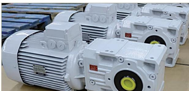
Der Zusammenbau von Serien erfolgt mit einer speziell dafür hergestellten Montageanlage. So werden Getriebemotoren montiert, mit Schmierstoff gefüllt und einem Probelauf unterzogen (siehe BEST auf letzter Seite).
