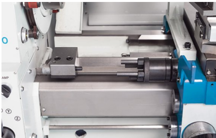
Wartungsfreundlichkeit und einfache Handhabung gewährleistet die im Support integrierte Zentralschmierung
