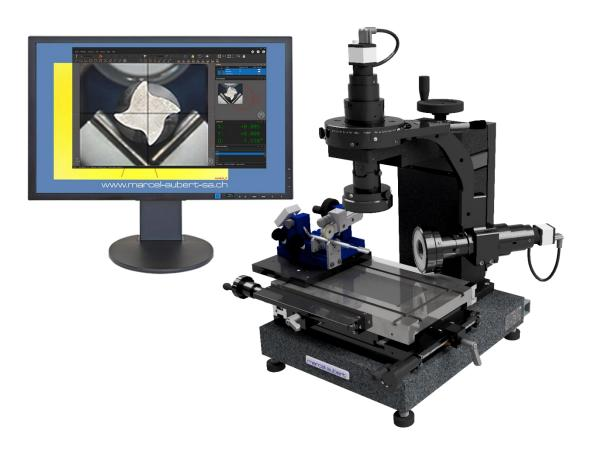
Messmaschine für die Vermessung von Schneidwerkzeugen. Die vertikale Optik wird verwendet, um Durchmesser und Längen an einem rotierenden Werkzeug zu messen. Die horizontale Optik ermöglicht die Messung am Werkzeugkopf und erlaubt eine zuverlässige Ausrichtung. Die zweite horizontale Optik dreht sich um das Werkzeug, ohne es zu bewegen, so dass mehrere verschiedene Winkel zuverlässig gemessen werden können.
