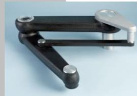
Dieser Roboter-Arm, welcher aus Carbon-Hochmodulfasern im Drucksack-Verfahren hergestellt wird, steigert dank systematischem Leichtbaukonzept die Anlagen-Performance um 40%.
