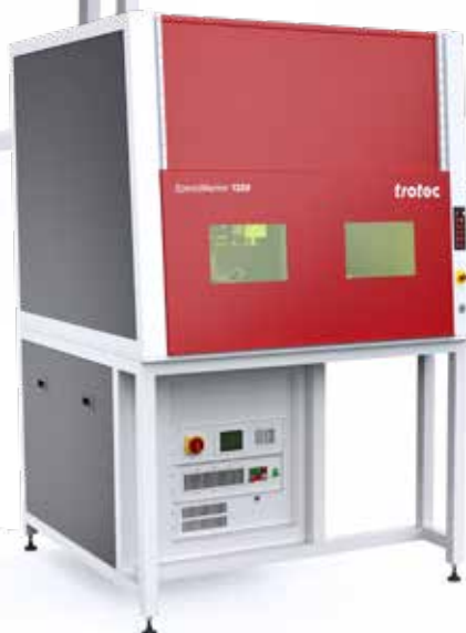
SpeedMarker 1350 Laserbeschrifteter mit verschiedenen Beladungskonzepten
