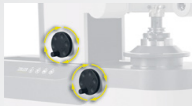
Manuelle Feinverstellung als Alternative zur CNC-Steuerung
