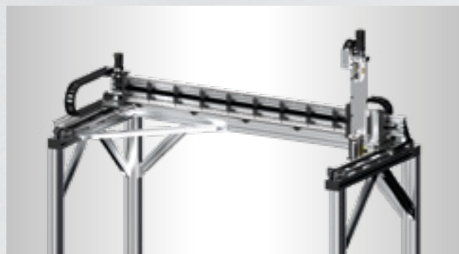
Raumportalroboter für das Handling von Werkzeugen
