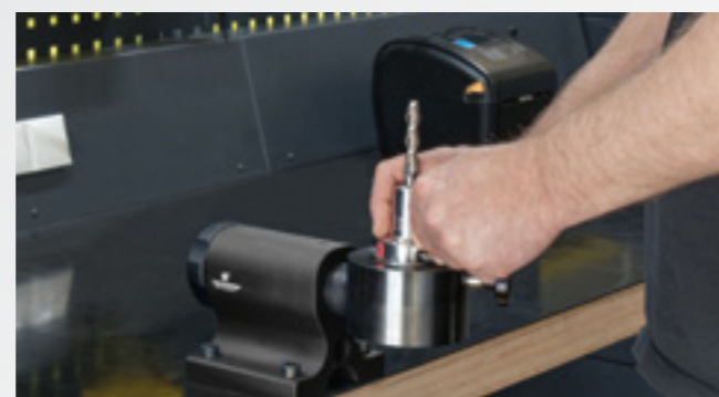
Montagevorrichtung zur sicheren Werkzeugmontage
