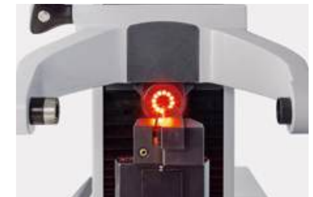
Drehmitten-Messkamera am Optikträger mit LED-Ringlicht
