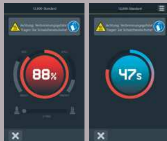
Statusanzeigen – ob Heiz- oder Kühlvorgang, »pilot« zeigt Ihnen jederzeit den Prozessfortschritt sowie wichtige Sicherheitshinweise an.
