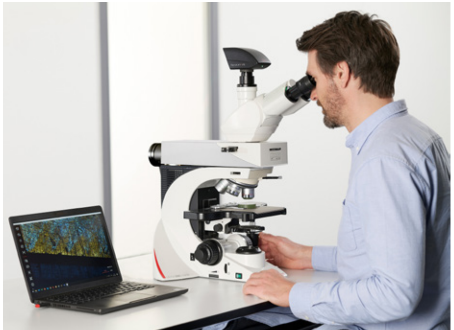
Das Lichtmikroskop DM2700 M mit der Flexacam c5 Kamera und der Desktop App der Enersight Softwareplattform.
